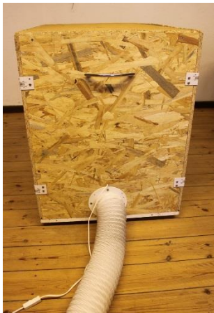
Abbildung 17: Durch einen Plastikschauch wird dem Ventilator Luft zugeführt und durch die Kiste geblasen. Die Trockenkiste wird mit einem Deckel verschlossen, der ein ca. 5 x 5 cm großes Loch für die Abluft hat.
